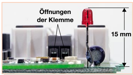
Bild 3: Einbau der LED D 1
