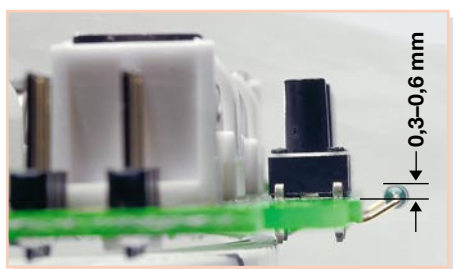
Bild 5: Abwinkeln des Reed-Kontaktes RK 2 (die Pfeile geben das Maß von der Platinenoberkante zur Reed-Kontakt-Oberkante an)
