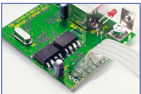
Bild 52: Sicherung der Lötstellen
