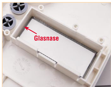
Bild 7: Polaritätsrichtiges Einsetzen des Displays
