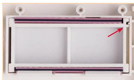
Bild 8: Montage der Leitgummistreifen mit Halterahmen
