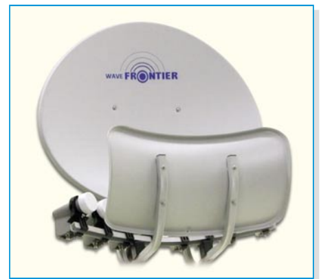
Bild 9: Bis zu 8 Speisesysteme finden bei der 55-cm-WaveFrontier ihren Platz vor dem Gregory-Subreflektor. Quelle http://www.multilnbdish.com/
