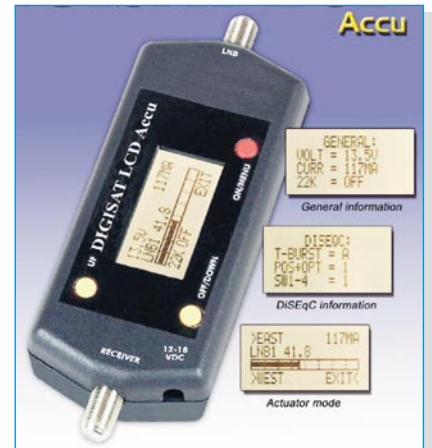
Bild 20: Ein erstaunlicher Funktionsumfang für knapp 70 €: Spannung, Strom, DiSEqC-Kommandogeb- und -leser, Ansteuerung von Rotoren, Summenpegel und manches mehr. Quelle: http://www.emitor.se/websites/emitorse/egnafiler/shop/admbilder/pdf/Digisat%20Lcd%20accu%20A4.pdf
