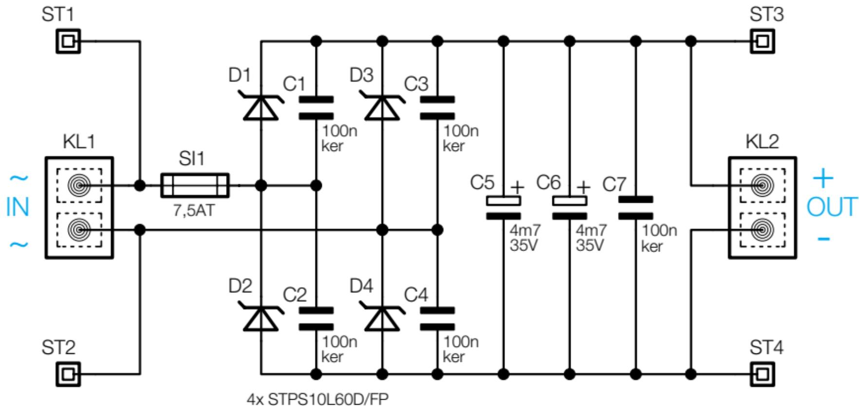
**Bild 4: Das Schaltbild des Netzteils**
