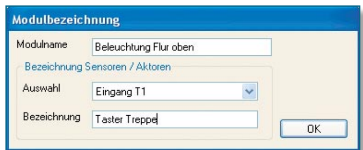
Bild 3: Jedes Modul, jeder Ein- und Ausgang sind mit dem jeweiligen Verwendungszweck beschriftbar.
