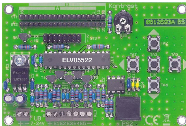
Ansicht der fertig bestückten Platine der LCD-Steuerung mit zugehörigem Bestückungsplan
