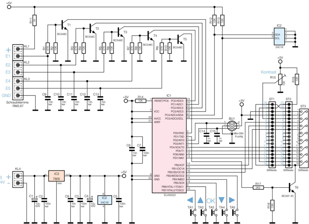
Bild 2: Schaltbild der LCD-Steuerung
