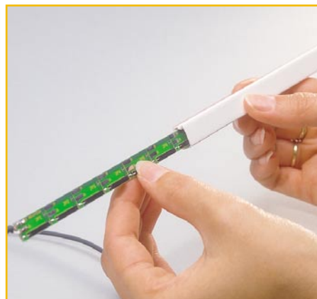
Bild 2: Einführung der Platine in den Mini-Installationskanal
