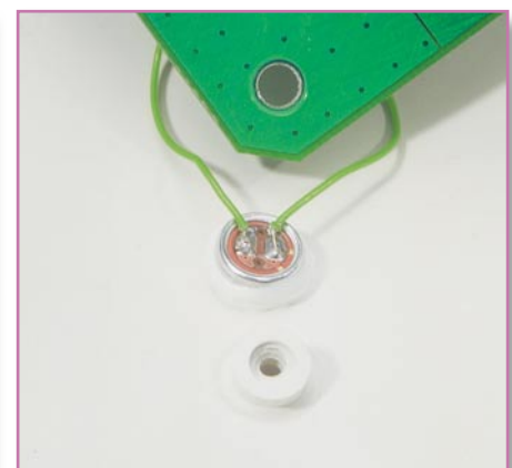
Bild 13: Korrekt angeschlossenes Mikrofon
