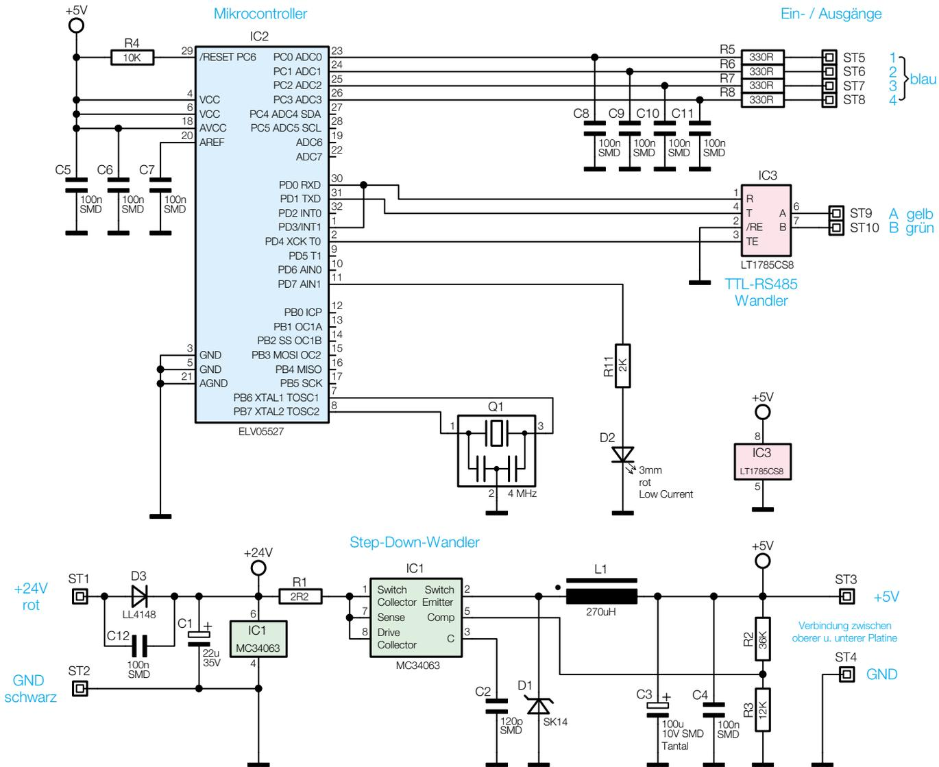
Bild 1: Das Schaltbild des I/O-Moduls
