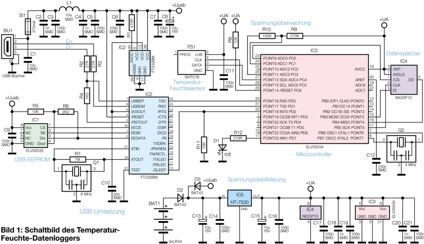
**Bild 1: Schaltbild des Temperatur-Feuchte-Datenloggers**
