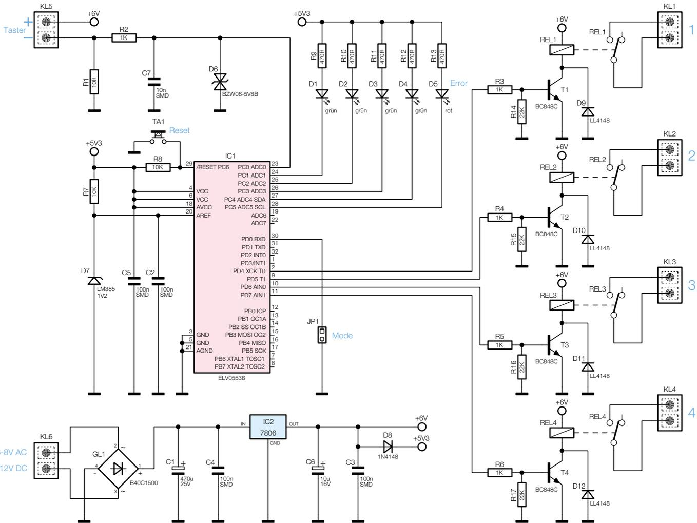
Bild 2: Schaltbild der Basisplatine
