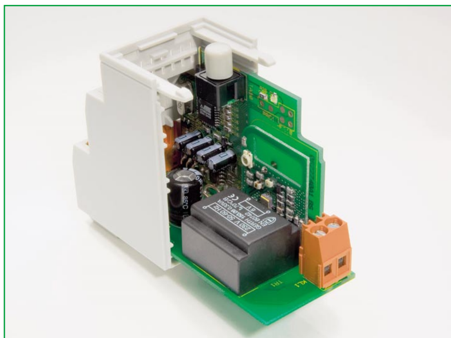
Bild 4: Das Einsetzen in das Hutschienengehäuse – auf saubere Führung der Platine in den Gehäusenuten achten!
