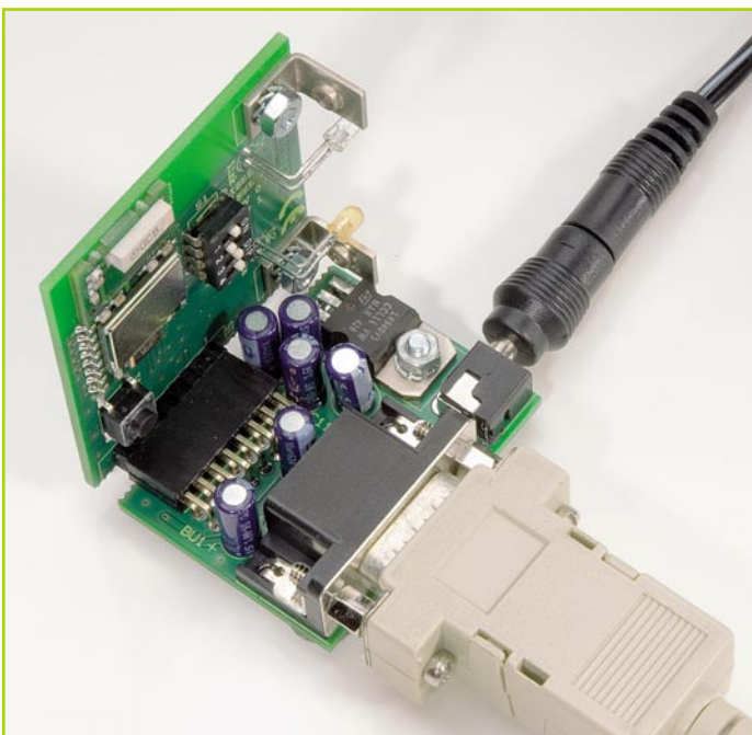
Bild 2: Anwendung als RS232-Bluetooth-Wandler bzw. Aufbau zum Programmieren des Moduls
