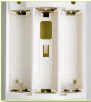
Bild 8: Batteriefach mit eingesetzten Kontakten
