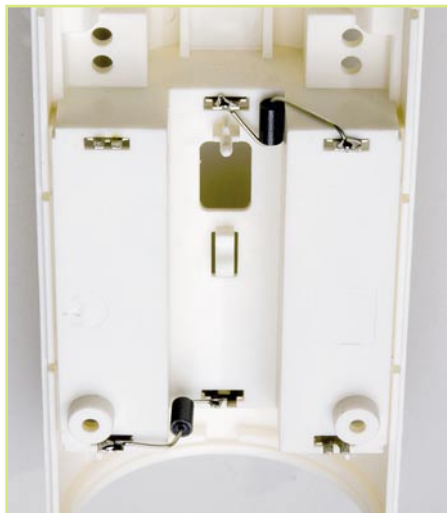
Bild 9: Verdrahtung der Batteriekontakte mit Dämpfungspettern
