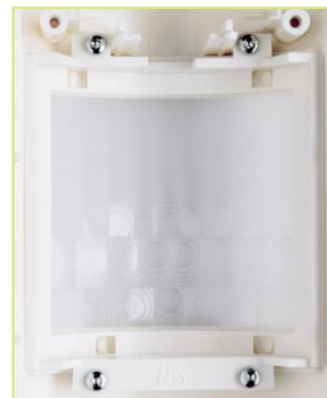
Bild 7: Hauptlinse und Linsenhalter im eingebauten Zustand
