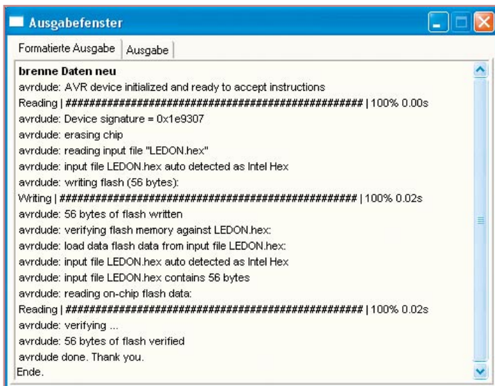
Bild 24: Im Ausgabefenster werden alle Vorgänge beim Brennen des AVR-Flash kontrolliert.
