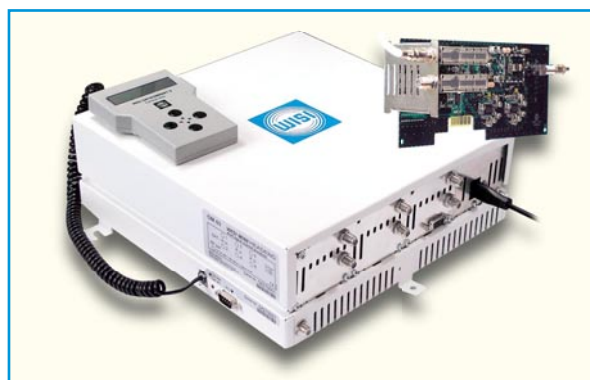
Bild 2: Eine typische kompakte Kanalaufbereitung für analoge und digitale Programme (Quelle WISI)
