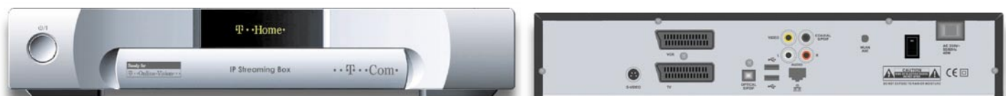
Bild 14: Sieht wie ein DVB-Receiver aus, ist aber eine IP-Set-Top-Box. (Quelle: T-Online)
