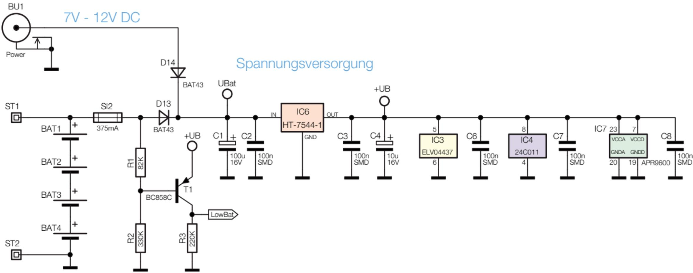
**Bild 4: Spannungsversorgung des AW 50**
