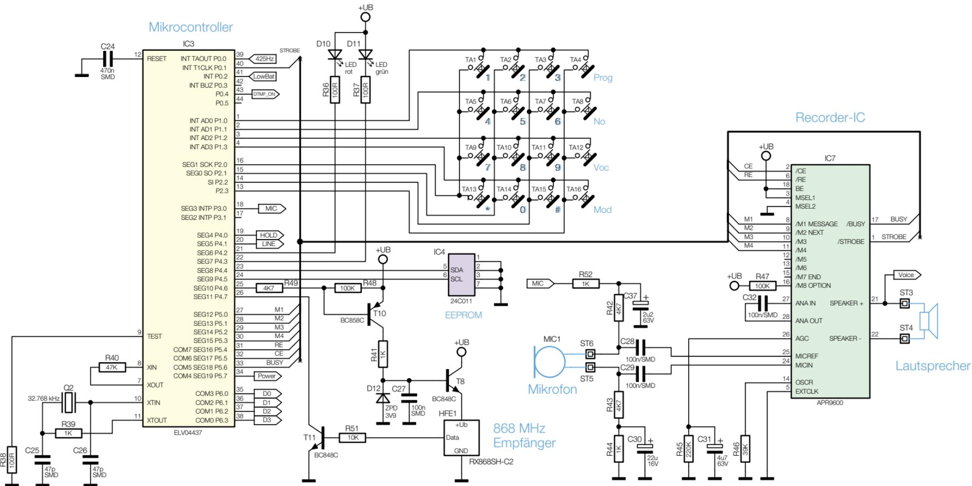
Bild 2: Mikrocontroller-Einheit des Alarmwählers AW 50
