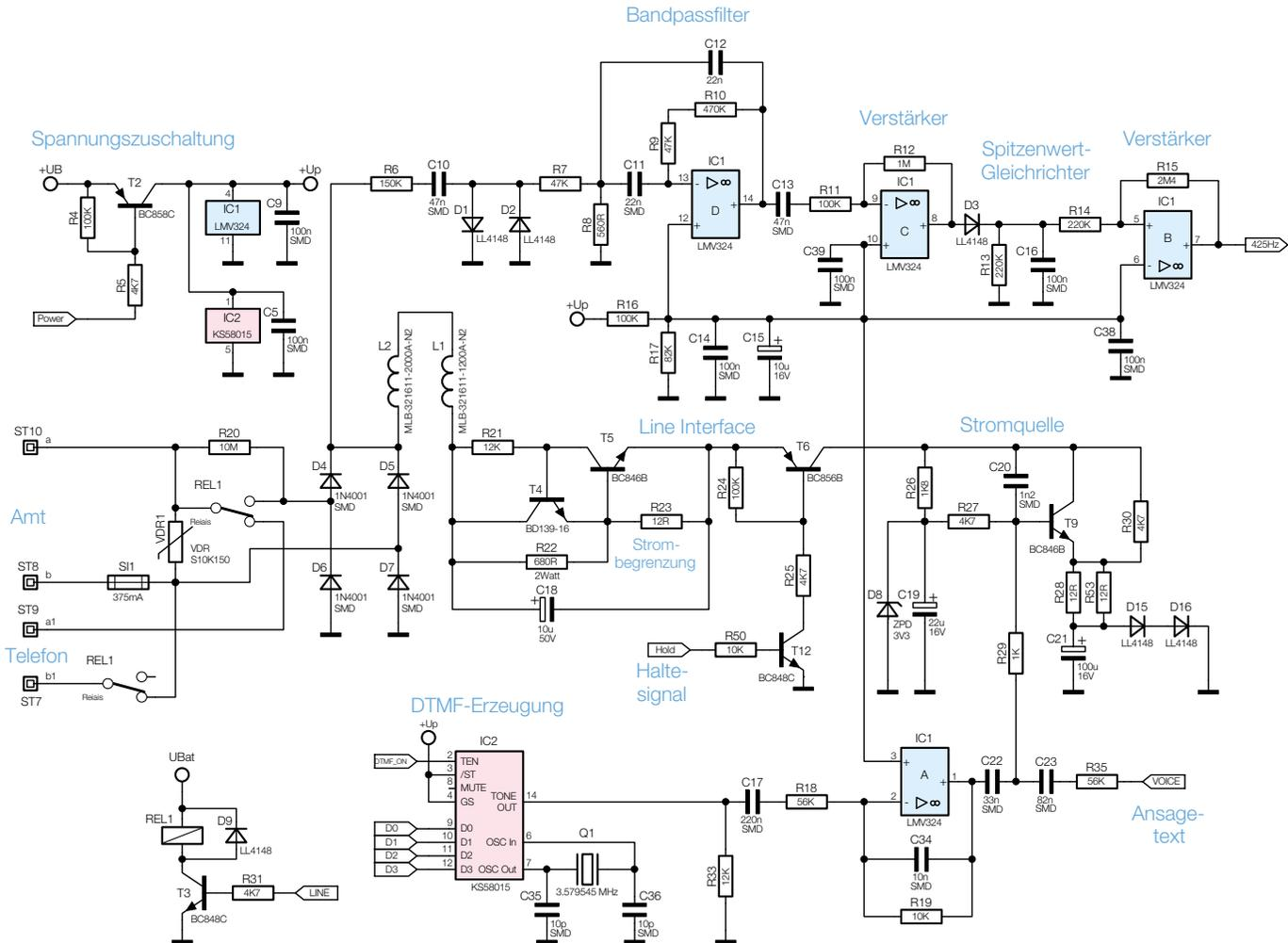
**Bild 3: Analogteil des Alarmwählers AW 30**
