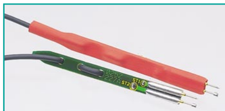
Bild 5: Spezial-Messleitungen mit federnd gelagerten Mess-Spitzen
