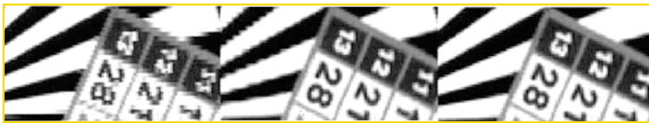
Bild 13: Die beste subjektive Verbesserung des Bildeindrucks hinterlassen hybride Deinterlacer. Im Bild rechts ist das Ergebnis eines hybriden Deinterlacers zu sehen, der die Methoden Directional Interpolation (DI, links) und Motion Compensation (MC, Mitte) kombiniert.
