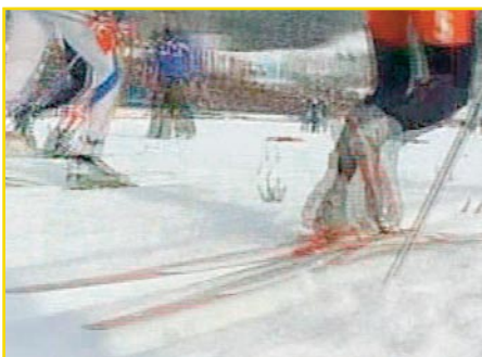
Bild 11: So sehen zwei aufeinanderfolgende überlagerte Halbbilder aus, die nicht mit einem Deinterlacer zu einem progressiven Vollbild zusammgeführt wurden.
