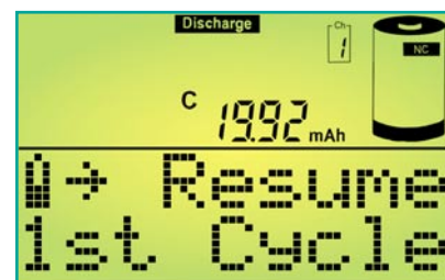
Bild 22: Anzeige der Entladekapazität
