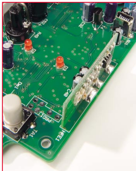
Bild 13: So montiert man den Funkempfänger auf der Platine
