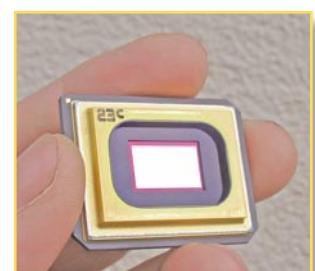
Bild 2: Über zwei Millionen einzeln beweglicher Spiegel sind auf diesem Chip angeordnet.
