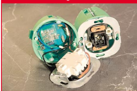
Bild 4: Beim probeweisen Zusammenbau gut zu sehen: Der Sender passt bequem hinter den Taster.
