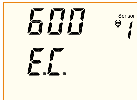
Bild 12: Einstellung der Zählerkonstanten
