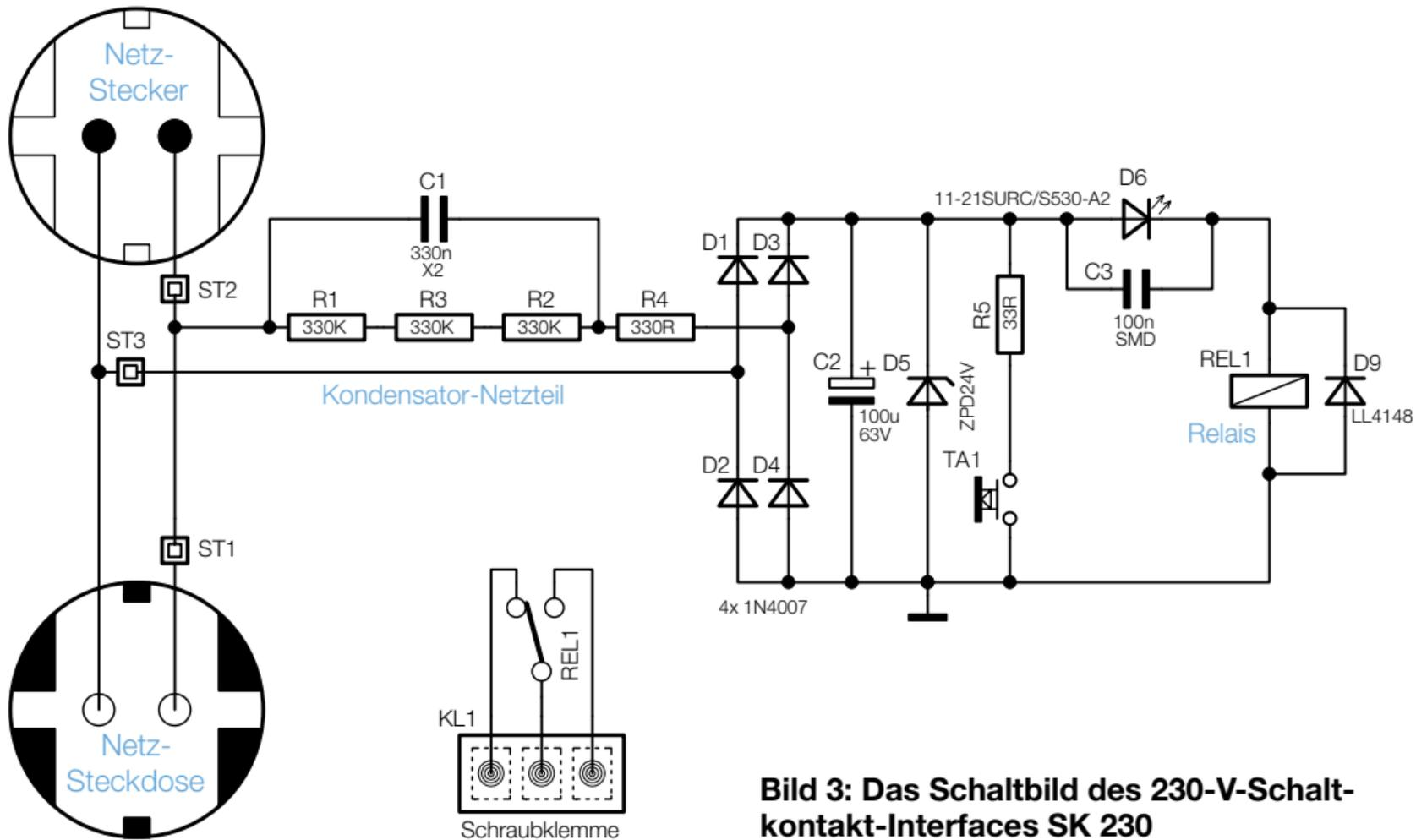
**Bild 3: Das Schaltbild des 230-V-Schaltkontakt-Interfaces SK 230**
