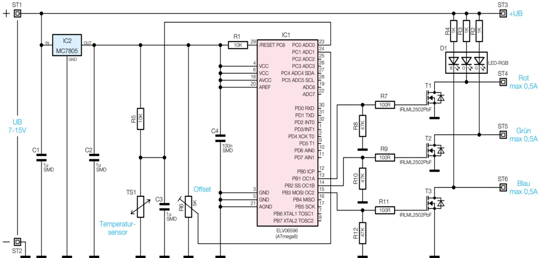
Bild 2: Schaltbild der RGB-Temperaturanzeige
