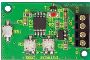
Ansicht der fertig bestückten Platine des Mini-Erschütterungs-sensors mit zugehörigem Bestückungsplan
