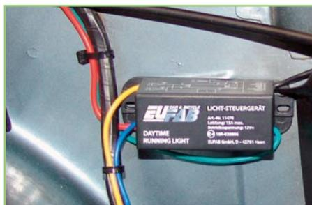
**Bild 9: Das montierte Tagfahrlichtrelais. Die Kabel werden entlang den vorhandenen Kabeln geführt.**
