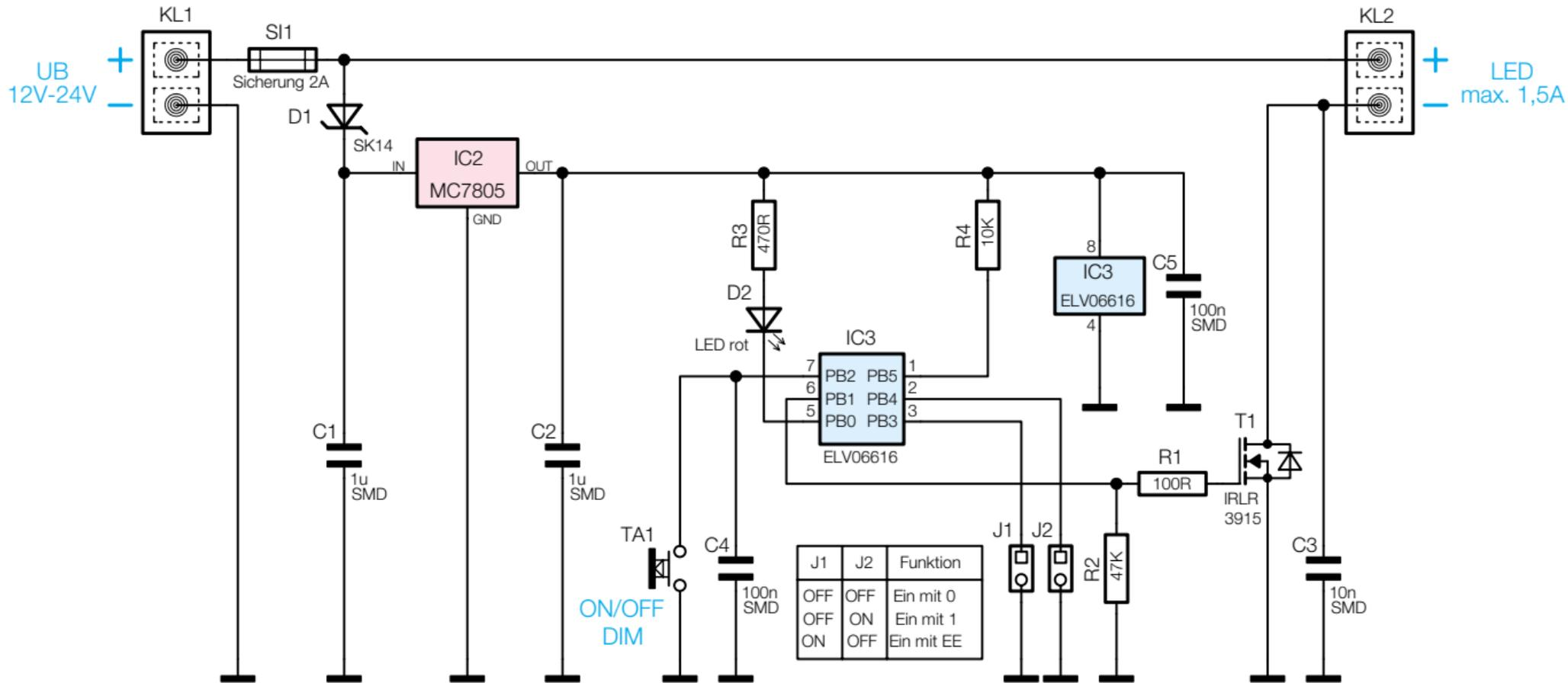
Bild 2: Schaltbild des Kabeldimmers
