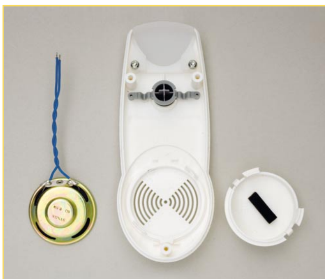
Bild 7: Innenansicht des Gehäusedeckels mit bereits eingeletem Lautsprechergitter, daneben der Lautsprecher und dessen Abdeckung mit eingeklebtem Schaumstoff
