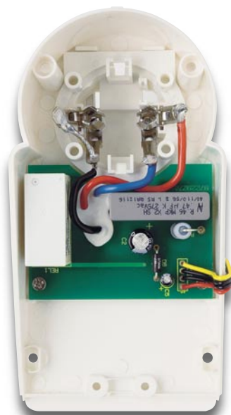
Bild 5: Die fertig verdrahtete Steckereinheit
