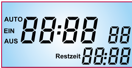
Bild 1: Alle verfügbaren Segmente des eingesetzten Displays
