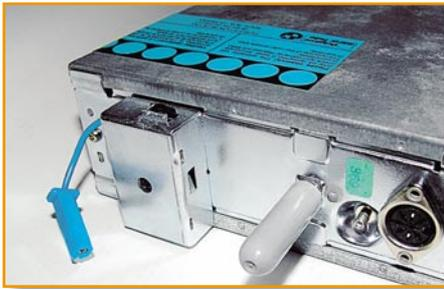
**Bild 8: Bei älteren Radiomodellen schnell zu finden – ist der blaue Anschluss an der Speed-Signalbox vom Fahrzeug aus belegt, hat man das Tachosignal gefunden!**
