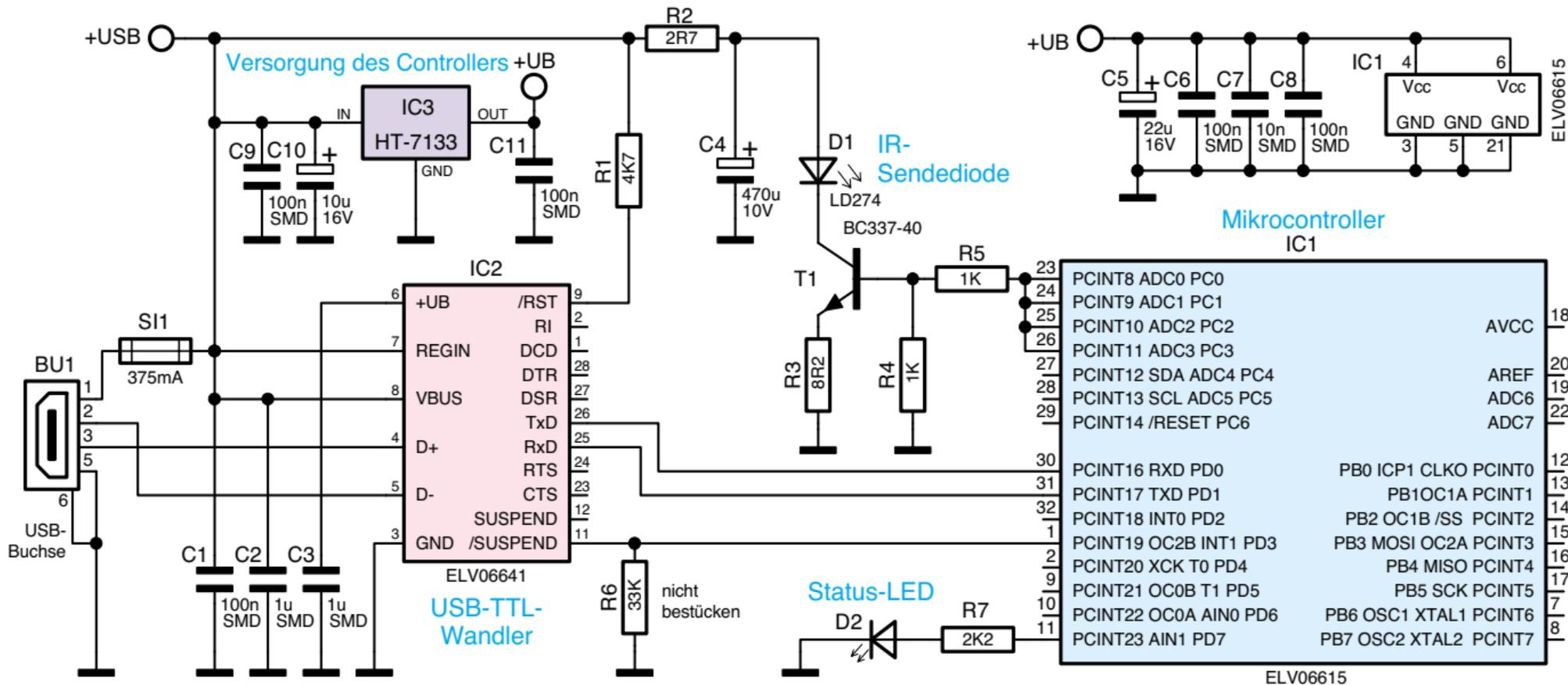
**Bild 5: Die Schaltung des FS20 IRP mit den vier Bestandteilen Stromversorgung, USB/TTL-Wandler, Mikrocontroller und IR-Sender**
