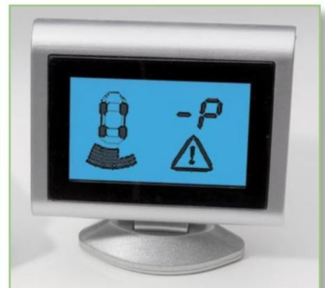
**Bild 1: Der blau beleuchtete Monitor des Rückfahrwarners zeigt Entfernung und die Lage des Hindernisses an. Hier ist bereits die Kollisionszone unter 30 cm erreicht – anhalten!**
