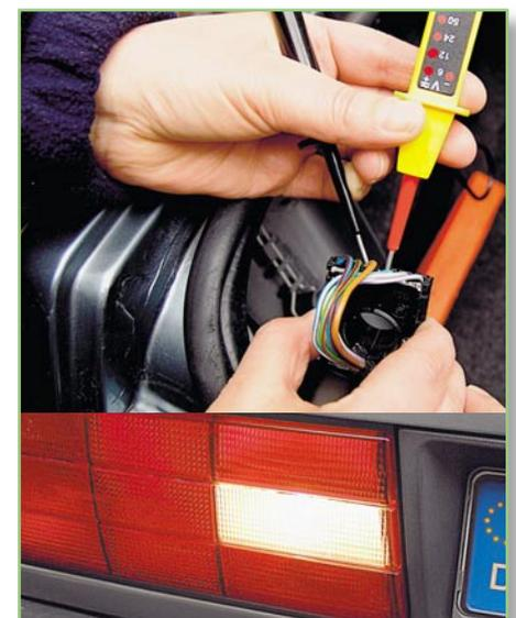
**Bild 6: Mit dem Spannungsprüfer findet man die Leitung für das Rückfahrtsignal sehr schnell – hier sind auch die blau-weiße Standardleitung für das Rückfahrtsignal und die braune Masseleitung gut zu sehen.**
