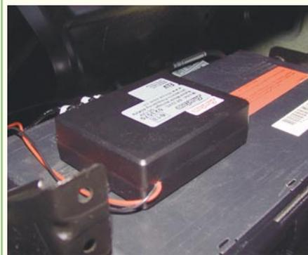
**Bild 5: Das Steuergerät fand hier auf dem CD-Wechsler hinter der Seitenverkleidung seinen Platz – einfach mit den bereits applizierten Klebestreifen aufkleben! Rechts die sehr einfache Beschaltung des Steuergerätes.**
