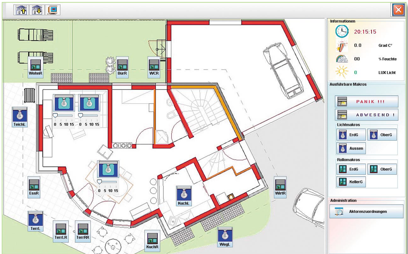
Bild 5: Die Programmoberfläche der Java-basierten PC-Steuerung mit den Direktbedienungs-Icons, dem Info-Bereich oben rechts und dem Makrosteuerungsbereich
