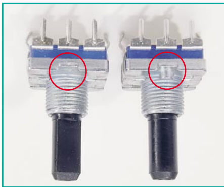
Bild 61: Die Führungsnase des Inkrementalgebers (rechts) wird abgeschnitten (links).
