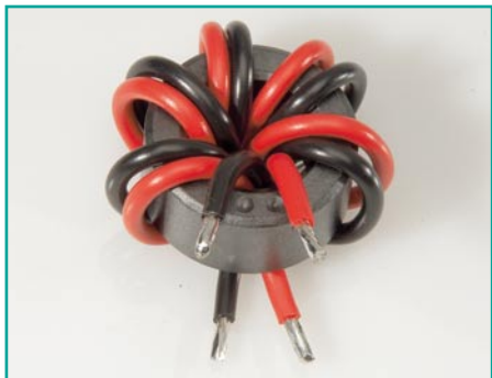
Bild 59: Durch den Ferritkern gefädelt
