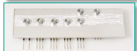
Bild 51 und 52: Vorbereitung der zu montierenden Kühlplatte
