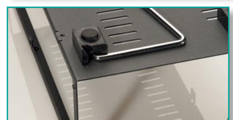
Bild 68 und 69: Montage der Gehäusefußmodule
