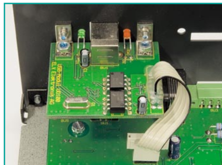
Bild 76: Verbindung von USB-Modul und Steckverbinder
