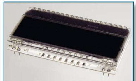
Bild 13: Das Display mit fertig montierter Hinterleuchtungsplatte
