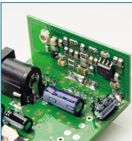
Bild 14: Die Basisplatine ist für das Anlöten eines optionalen HF-Empfangsmoduls vorbereitet.
