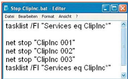
**Bild 11: Mit wenigen Zeilen in einer Batchdatei lassen sich alle oder gezielt einige Dienste abschalten.**
