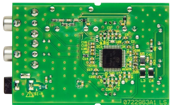
Platinenfoto des Stereo-Infrarot-Senders mit zugehörigem Bestückungsdruck, links von der Platinenoberseite, rechts von der SMD-Seite
