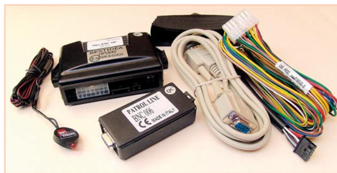
Bild 4: Die Can-Bus-Line-Alarmanlage mit Zubehör und PC-Interface
