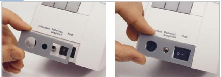
Eine Kunststoff-Abdeckung aus selbstklebender Folie ist, wie abgebildet, im vorderen Bereich über den Netzschalter und die Buchsen zu kleben.
