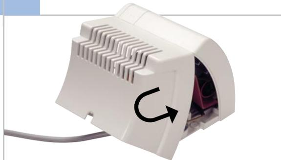
Das Gehäuseoberteil wird zuerst (wie abgebildet) oben in die Fronteinheit eingerastet und dann ist das Gehäuse halbkreisförmig zu schließen. Dabei ist das Gehäuse im unteren Bereich etwas auseinander zu biegen. Vorsicht! Es ist unbedingt darauf zu achten, dass zwischen den Schraubdomen kein Kabel eingeklemmt wird.
