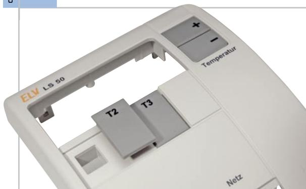
Im nächsten Arbeitsschritt werden die 5 Bedientasten in die Gehäusefront eingerastet.
