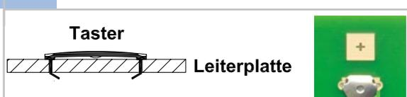
Von der SMD-Seite sind die Tasterkontakte (Knackfrösche) wie abgebildet zu bestücken. Damit die Kontakte nicht wieder herausfallen können, sind die Pins wie abgebildet an der Platinenseite für bedrahtete Bauelemente umbiegen und nicht zu verlöten.
