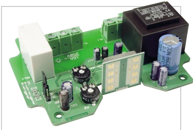
Bild 5: Die vertikale Montagemöglichkeit des Radarsensors
