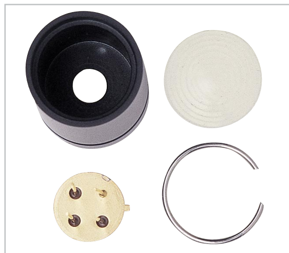
Bild 5: Einzelkomponenten des Linsensystems
