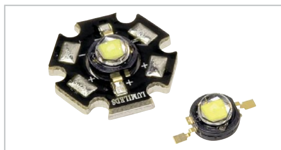
Bild 1: Die beiden verbreitetsten Bauformen der Luxeon-Power-LEDs. Während die Hexagon-Form die notwendigen Kühlflächen bereits enthält, sind für die so genannte Emittor-Bauform entsprechende Kühlflächen erforderlich.
