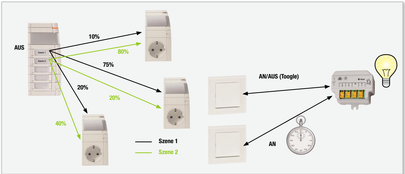
Bild 4: Links: szenisches Licht. Rechts: Treppenhauslicht und normaler Toggle-Taster (Funktion wie Stromstoßschalter)
