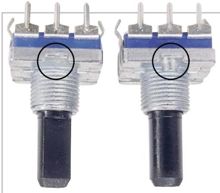
**Bild 14:** Die Führungsnase des Inkrementalgebers (rechts) wird abgeschnitten (links).
