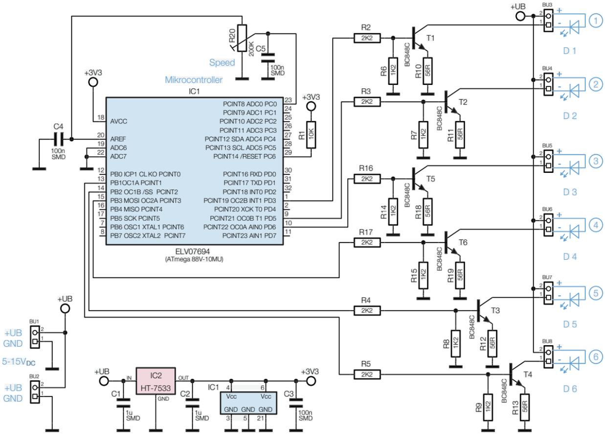
Bild 1: Das Schaltbild der LED-Sternenhimmel-Steuerung
