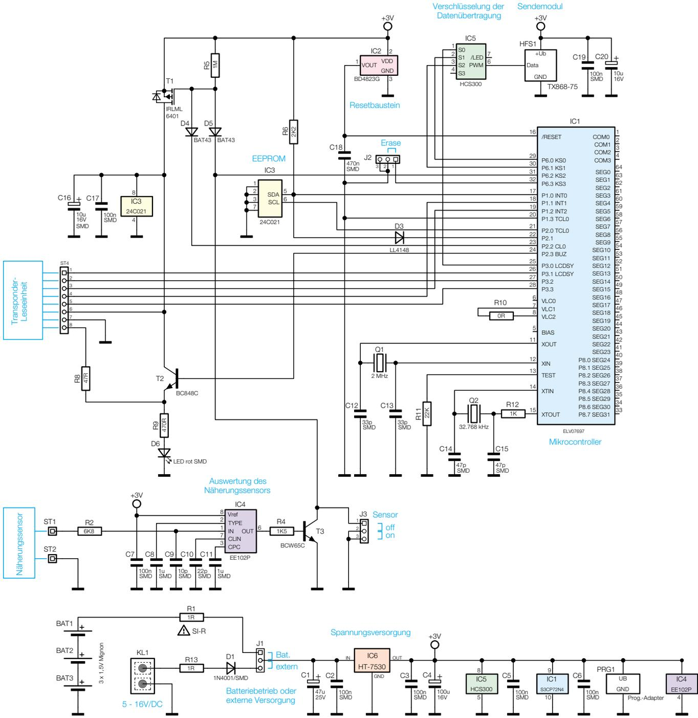
Bild 3: Schaltbild der Basisplatte
